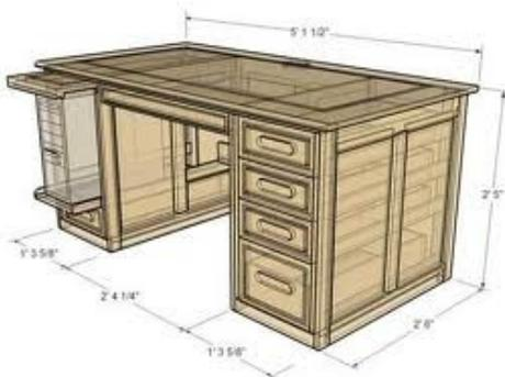
Exemple de maquette numérique réalisée avec un logiciel de CAO : Sketchup
