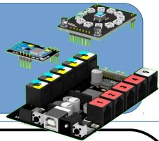
Doté de 6 paires de capteurs infrarouges (émetteur /récepteur), ce module est spécialement conçu pour réaliser des robots suiveur de ligne de précision (noire sur fond blanc ou inversement). Sortie tout-ou-rien.
